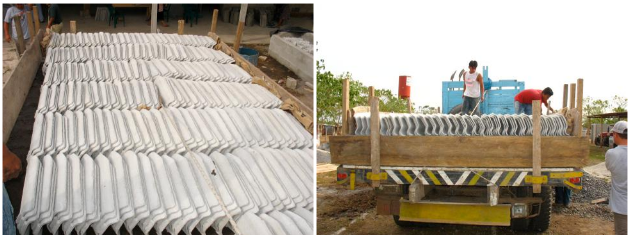
Tejas colocadas para su transporte
