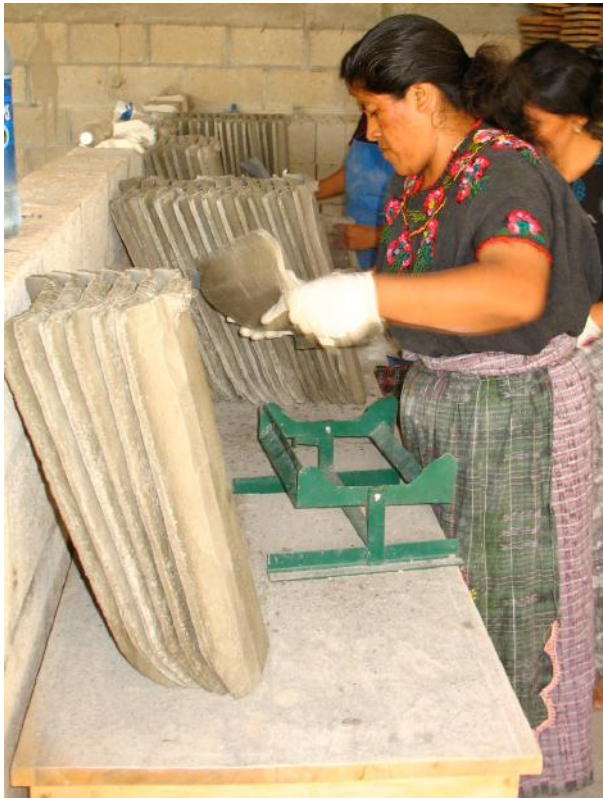
Operaria utilizando la guía de verificación
